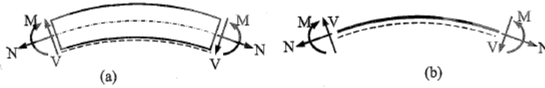
Şekil 2.3 Eğri eksenli çubuklarda kesit tesirlerinin pozitif yönleri
