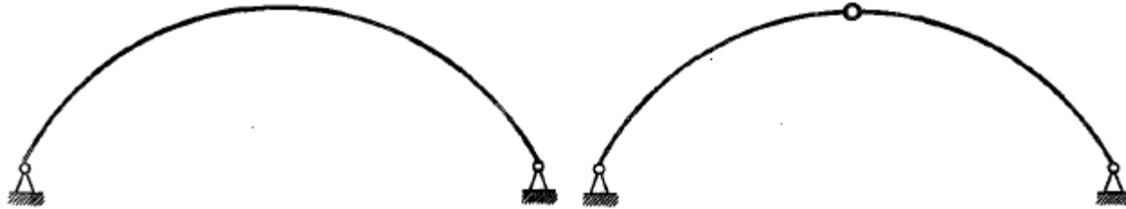
Şekil 2.16b Mafsal ilave edilerek izostatik hale getirilmiş üç mafsallı kemer
