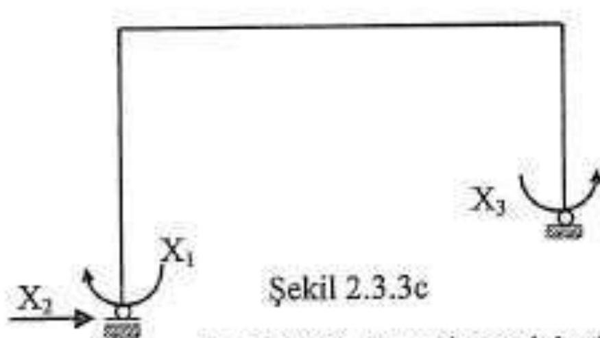
Şekil 3.2.3 Aynı sistem için değişik izostatik esas sistemler ve hiperstatik bilinmeyen kuvvetler
