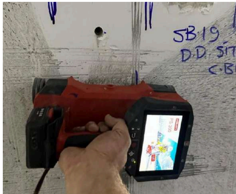
Şekil 2.7.1 Paşometre ile donatı haritalandırılması
