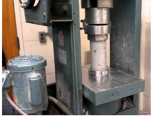
Karot Numunenin Kırılması
