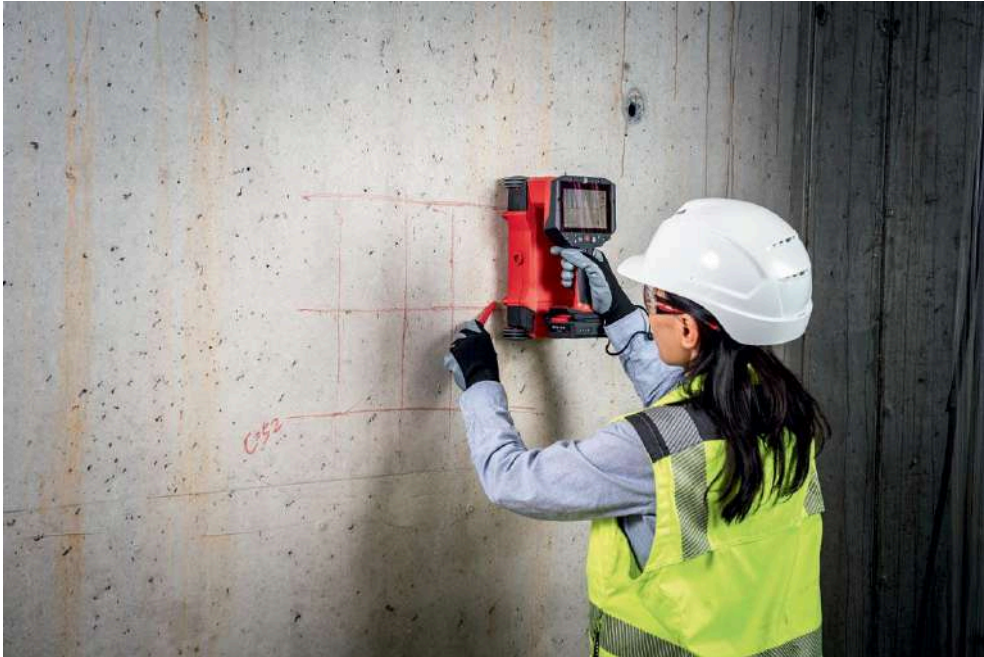
Şekil 2.3.2 Duvar Arkası Demir Tarama Cihazının Görseli
