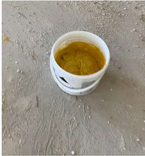
Şekil 4.9.18 Epoksi Reçine Çift bileşenli olarak kutusu içerisinde karıştırılarak yüzeye sürülmeye hazır hale getirilir
