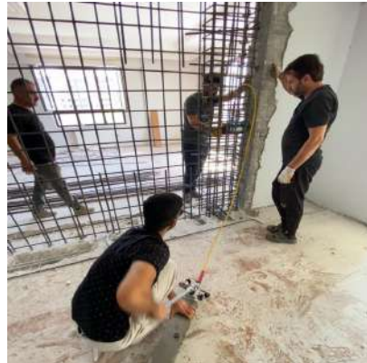
řekil 4.9.9 Rastgele seilen filiz donatılara hidrolik kriko ile ekme (pull-out) testi uygulanması
