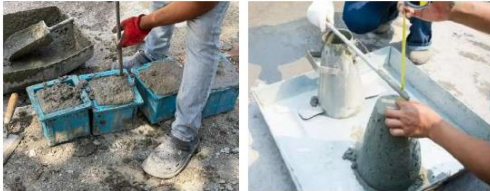
Şekil 4.9.14 Taze betondan numune alımı ve slump deneyi yapılması
